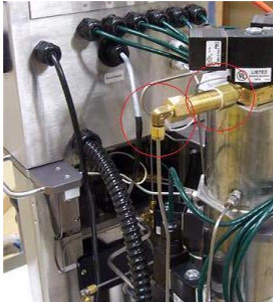
背面图，外壳被卸下 1- 压缩配件 2- 过滤装置
