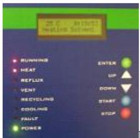
E 加热溶剂，压力升高，并显示提取时间和温度。
