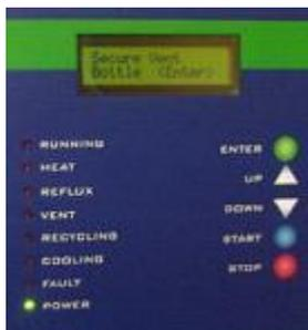
B 提示将溶剂回收瓶安装好
