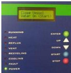
D 关闭缸体，开启冷却水
