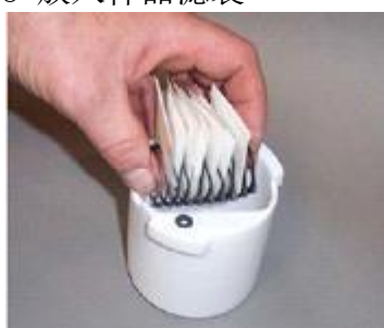
检查密封圈完好，放回提取罐
